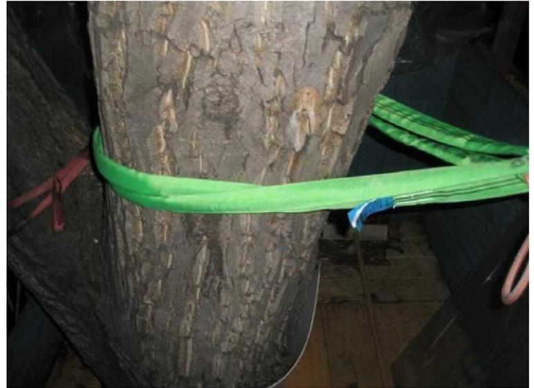
Schlinge aus Bandmaterial, deren Belastungsrichtung im rechten Winkel zum Stamm/Ast verläuft, und die nicht als Würgeschlinge ausgebildet ist
